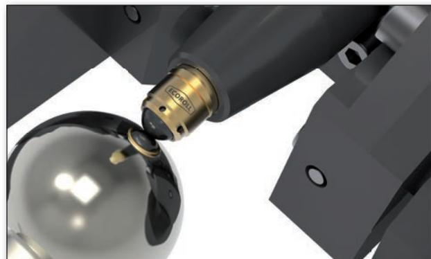
Glattwalzen eines Kugelgelenkes
