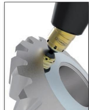
Glattwalzen der Kugelzone eines Kegelrades.
